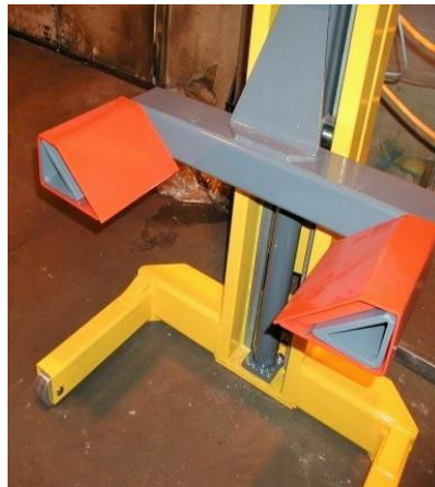
Adaptery do małych kół: adapter / zakres dla koła = 700 – 900 mm Adapter /zakres dla koła = 500 – 700 mm
