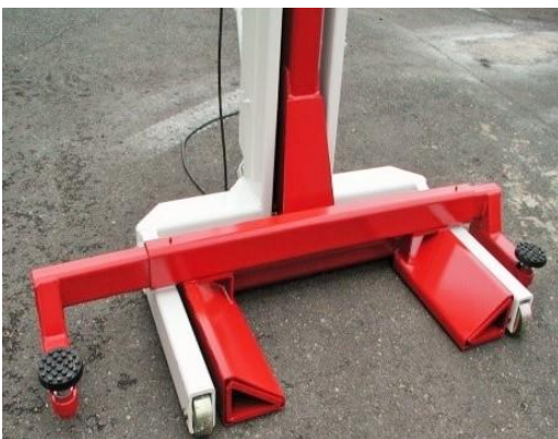
HDL – 108/1 Adapter z nadstawką do podnoszenia samochodów osobowych i typu Van o udźwigu 2 tony (komplet 2 szt) = możliwość wykorzystania jako podnośnik 2-kolumnowy o udźwigu 4 ton
