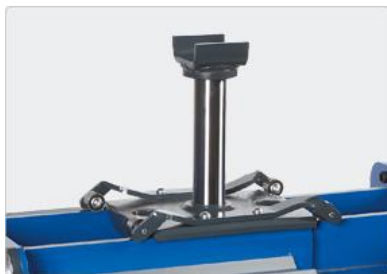
Nadstawka typu U do podnoszenia różnych typów profili podwozia Rozstaw - 100 mm i 130 mm
