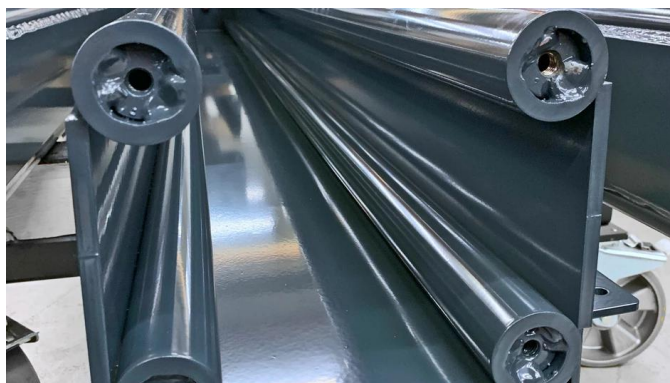
Kolumny wykonane są na konstrukcji rurowej, spawanej
