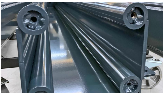
Kolumny wykonane są na konstrukcji rurowej, spawanej
