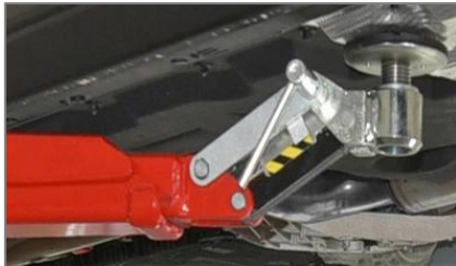
CF = końcówka łapy typu Combiflex
