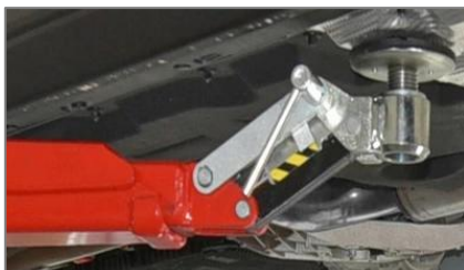
CF = końcówka łapy typu Combiflex
