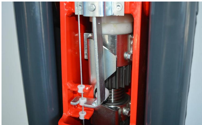
System nakrętki głównej i zabezpieczającej
