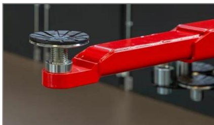
F = talerzyk w końcówce łapy typu Flex (wymienny z bolcem)
