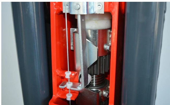
System nakrętki głównej i zabezpieczającej
