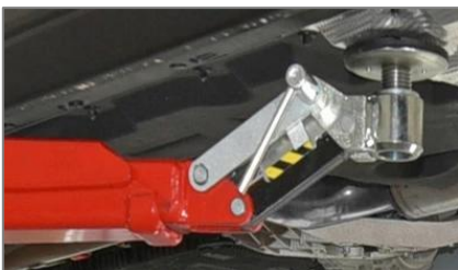
CF = końcówka łapy typu Combiflex
