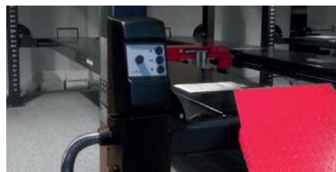
Skrzynka sterownicza na kolumnie
