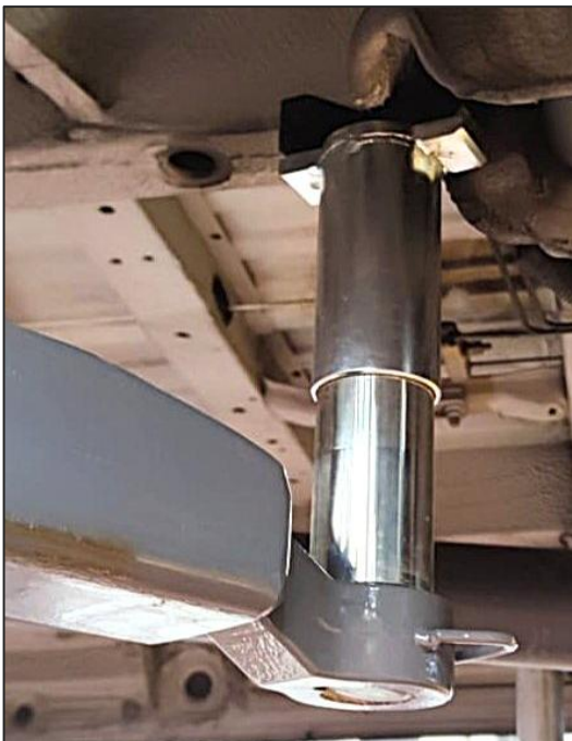
11043 - Zestaw 2 nadstawek typu „pryzma” dedykowane do podnoszenia samochodów "Crafter/Sprinter" Ø 40mm
