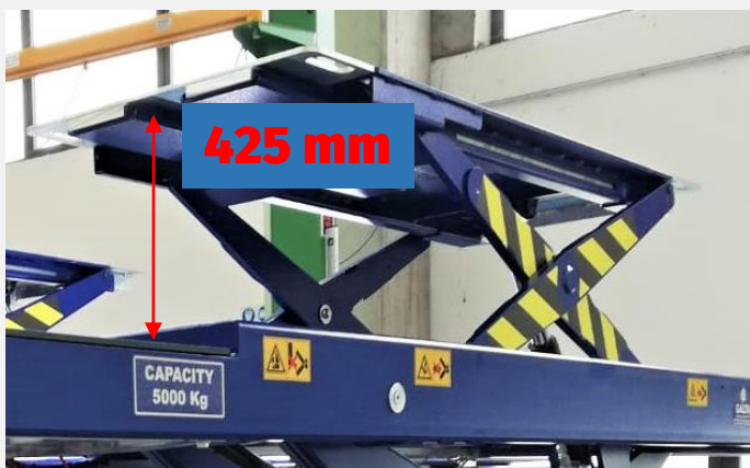
Wysokość podnoszenia małej nożyicy 425 mm
