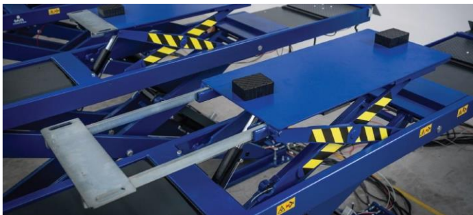
Podnośnik „mała nożyca” LT w stanie rozłożonym
