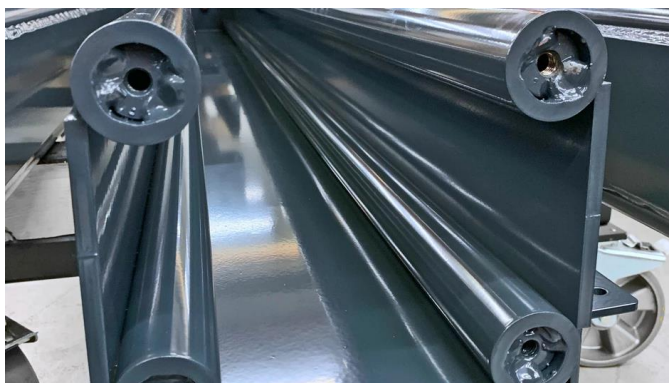
Kolumny wykonane są na konstrukcji rurowej, spawanej
