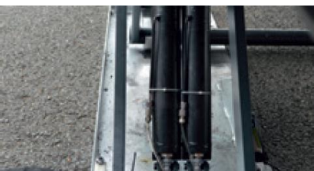
Dwa cylindry pod każdą sekcją nożyc
