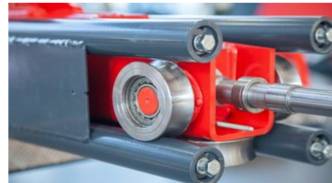
Płynna praca dzięki wózkom z łożyskami tocznymi
