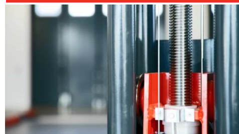
Walcowana na zimno i centrowana śruba nośna
