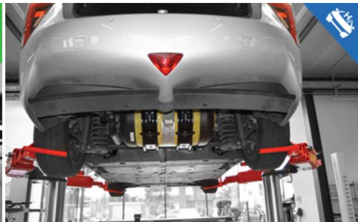
Pojazd wodorowy: swobodny dostęp do podwozia
