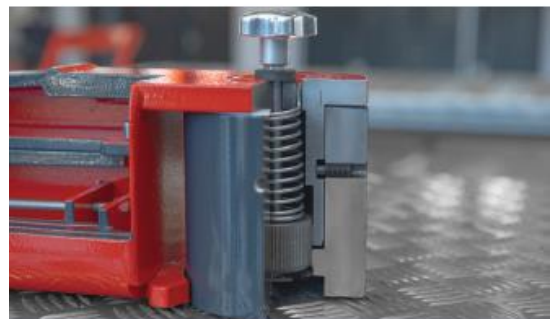
Wewnętrzna blokada ramion
