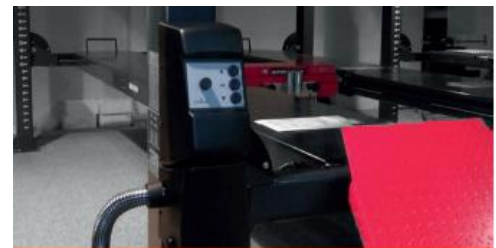
Skrzynka sterownicza na kolumnie
